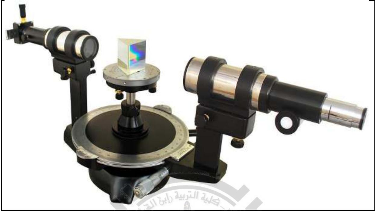
**هدف التجربة:** استخدام المطياف لتحقيق قانون كوشي (Cauchy) ، لتعيين قدرة التحليل والتفريق للموشور
