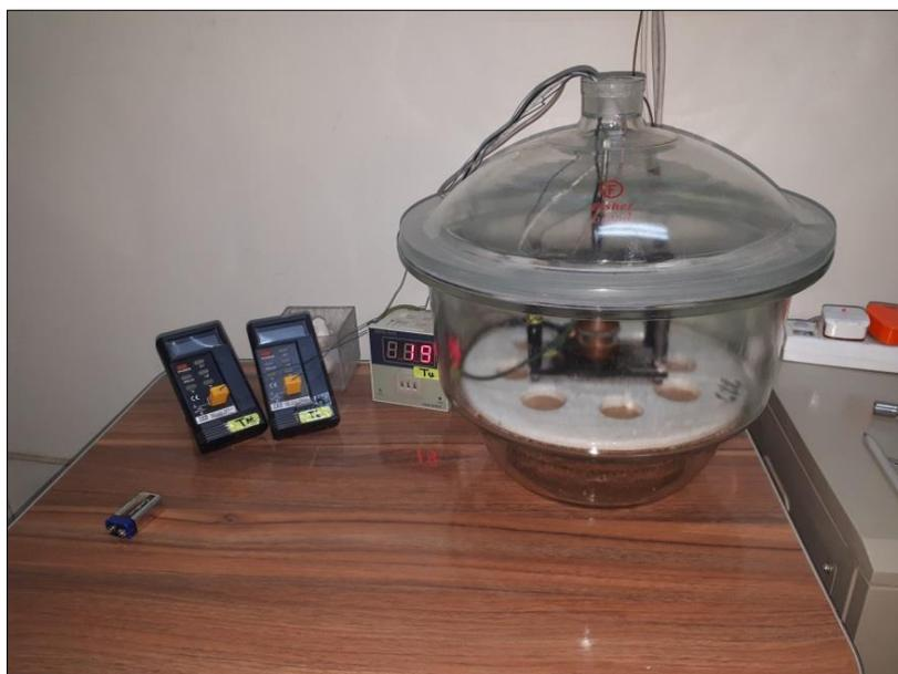
الشكل (3-4): الجهاز قياس التوصيلية الحرارية (قرص لي).
