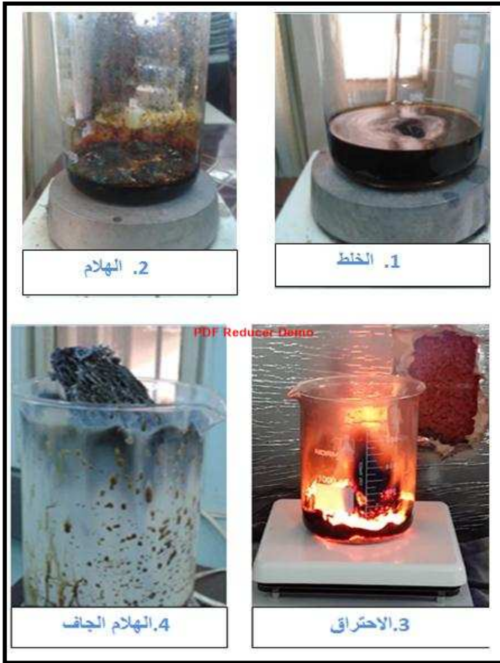
الشكل رقم (3 - 1) مراحل اعداد الفرايت بطريقة السول - جل ذات الاحتراق التلقائي
