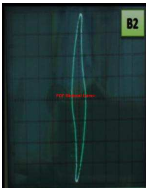
الشكل(4-31) حلقة الهسترة لعينات المجموعة (B)
