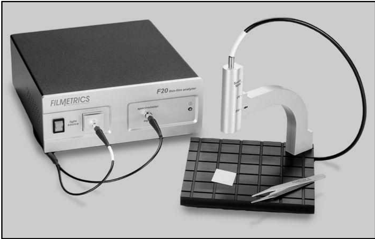
الشكل (3-8) صورة فوتوغرافية للمقياس الطيفي العاكس والمستخدم في قياس سمك الاغشية المحضرة
