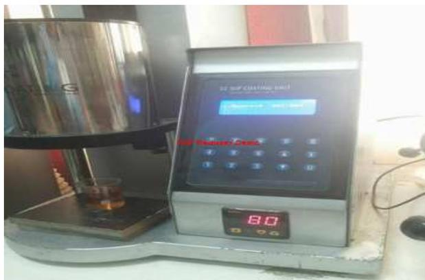
جهاز الطلاء بالغطس Dip-coating Device
