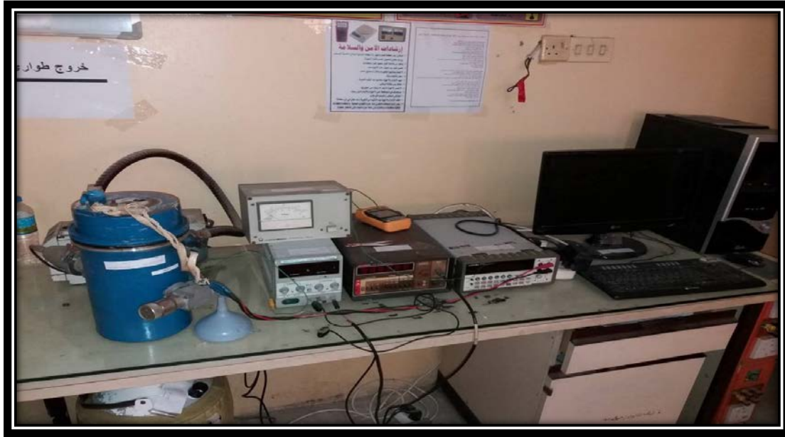
الشكل (3-2) الصورة الحقيقية لاجهزة قياس درجة حرارة الانتقال الحرجة ( T_c ).
