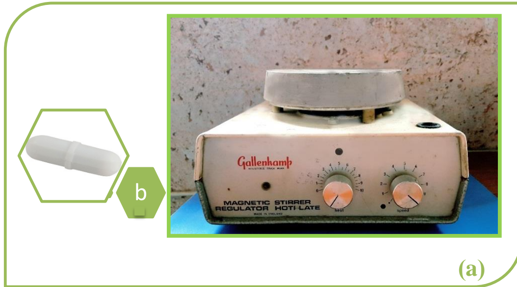
الشكل (2-3) (a) الخلاط المغناطيسي (b) القطعة المغناطيسية
