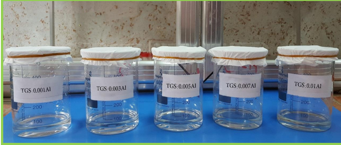
الشكل (6-3) طريقة التبخر البطيء لكبريتات ثلاثي الكلايسين المطعمة بأيونات الألومنيوم.
