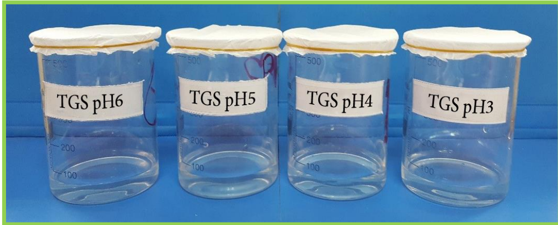
الشكل (4-3) طريقة التبخر البطيء لكبريتات ثلاثي الكلايسين في وسط حامضي.
