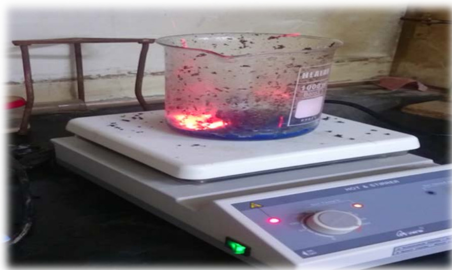
الشكل (3-3): مرحلة تحضير المركب النانوي (\text{Pb}_{1.5}\text{Cu}_{1.5}\text{Ba}_5\text{Ca}_5\text{Cu}_8\text{O}_{18-8}) بطريقة السول – جل ذات الاحتراق التلقائي .
