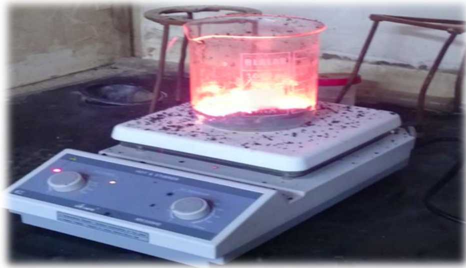
الشكل (1-3): مرحلة تحضير المركبين ( YBa_2Cu_3O_{7-\delta} ) ، ( Y_3Ba_5Cu_8O_{18-\delta} ) بطريقة السول – جل ذات الاحتراق التلقائي .
