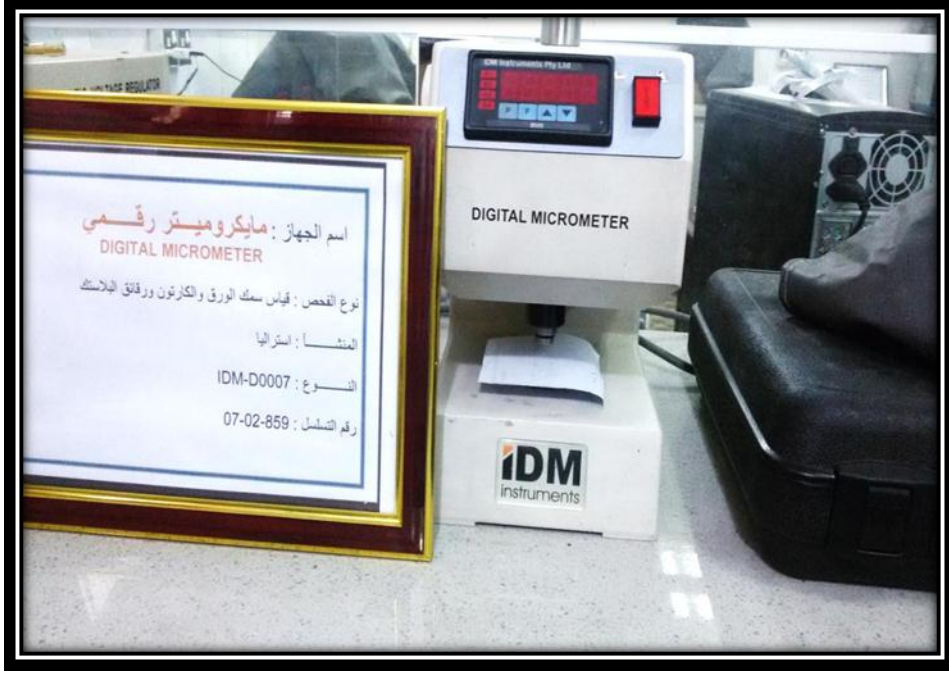
شكل (3-4) جهاز المايكروميتر الرقمي Digital Micrometer لقياس سمك العينات
