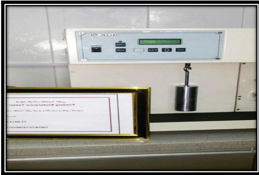
شكل (6-3) جهاز قياس مقاومة الطي للعينات الورقية
