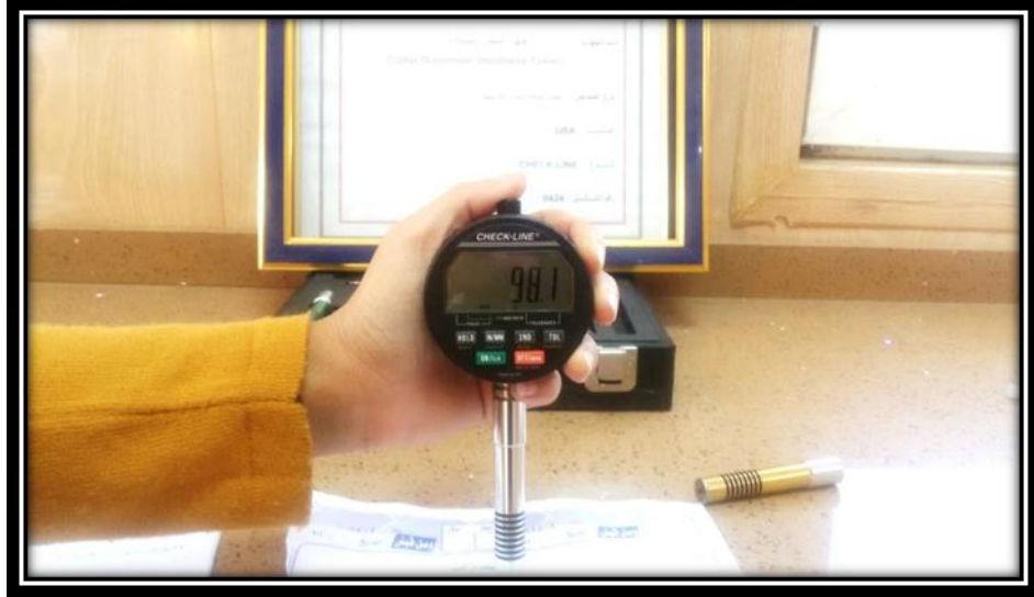
شكل (5-3) جهاز اختبار الصلادة (Digital durometer)
