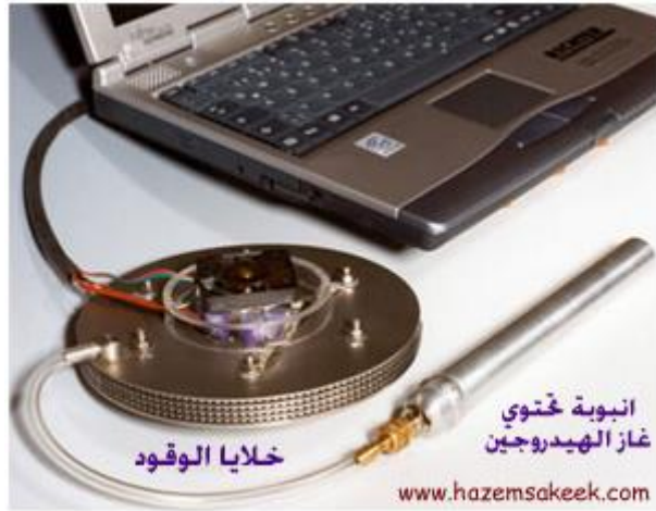
الشكل (٤) يوضح جهاز كمبيوتر دفتري يحصل على الطاقة الكهربائية من خلية وقود هيدروجينية
