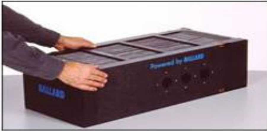
الشكل (٥) يوضح شرائح من خلايا الوقود الهيدروجينية تستخدم كمصدر للطاقة في السيارات
